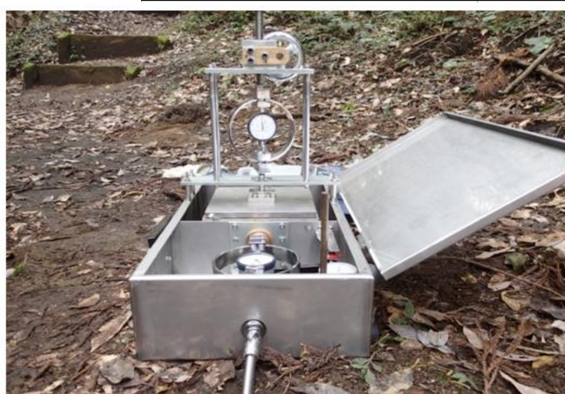
開発した現場一面せん断試験装置
